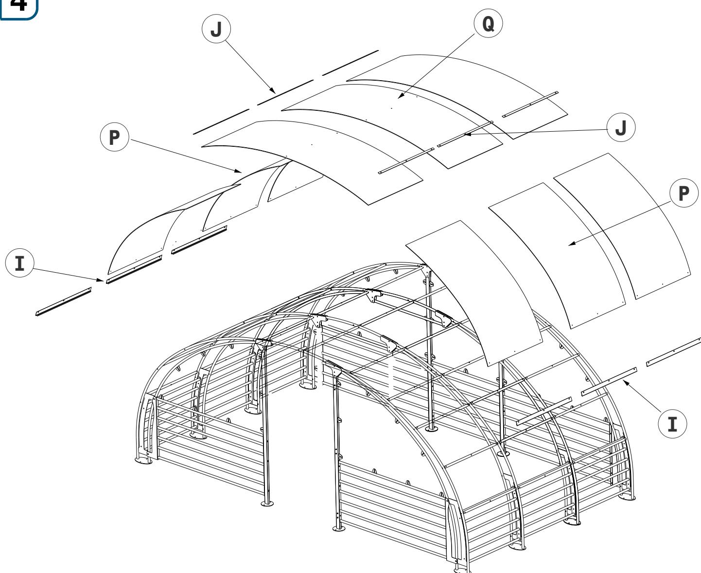
Toiture centrée sur la longueur et la largeur de l'abri
