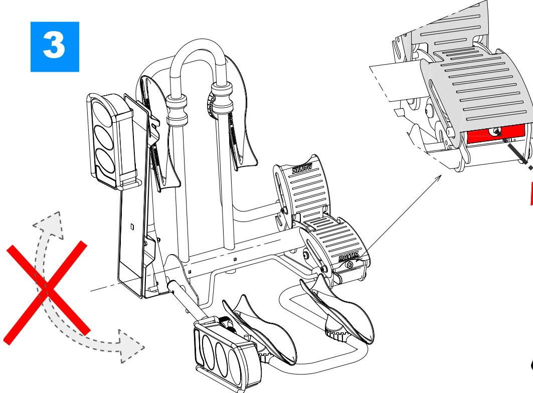
Régler la force de serrage sur la boule avec la vis de réglage
