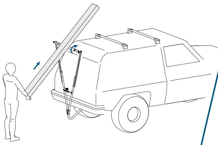
Attacher le chargement aux barres de toit mais pas sur le dispositif de prolongement
