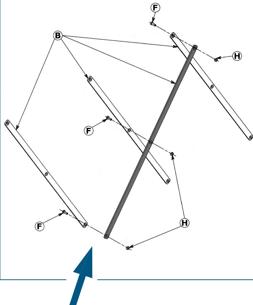
Positionner les bossages des barres **B** face à face, de façon à limiter les frottements.
